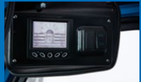
Multifunktionales LCD-Display inkl. Betriebsstundenanzeige, Tank-, Kühlwasser und Temperaturanzeige
