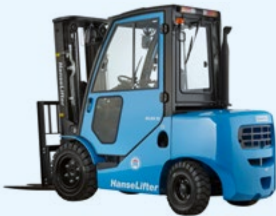
Dieselstapler mit 1,5 bis 10,0t Tragfähigkeit
