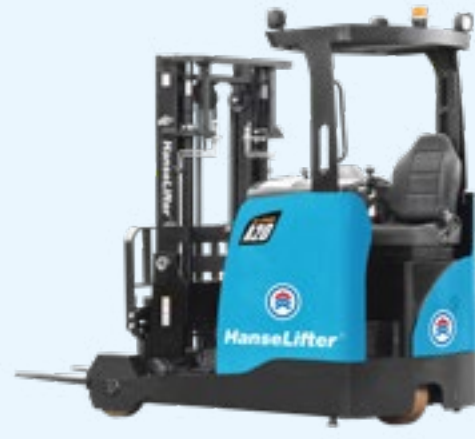
Schubmaststapler mit 1,2 bis 2,0t Tragfähigkeit
