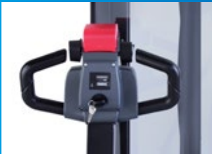
Ergonomischer Deichselkopf mit Batterie- und Betriebsstundenanzeige
