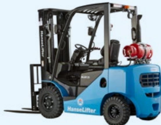
Treibgasstapler mit 1,5 bis 7,0t Tragfähigkeit
